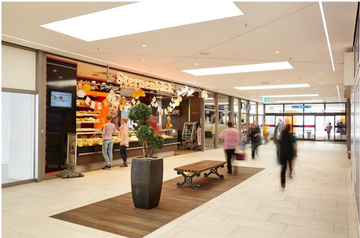
Das Beleuchtungskonzept im Einkaufszentrum wurde nach ökologischen Nachhaltigkeitsaspekten überarbeitet. Durch den Austausch der Leuchtstoff-Einzelneuchten der Mall in LED-Großfeldleuchten und konventioneller Downlights in LED-Spots sowie durch den Einbau von LED-Lichtbändern konnte nicht nur der Leuchtmittelverbrauch gesenkt, sondern vielmehr eine Energieeinsparung und somit eine Senkung der Stromkosten um ca. 20 % erzielt werden.
