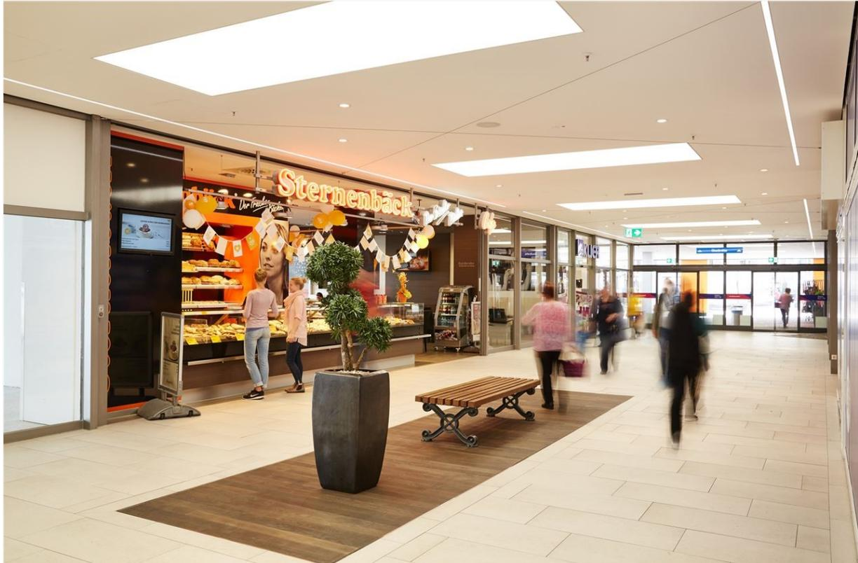
Das Beleuchtungskonzept im Einkaufszentrum wurde nach ökologischen Nachhaltigkeitsaspekten überarbeitet. Durch den Austausch der Leuchtstoff-Einzeleuchten der Mall in LED-Großfeldleuchten und konventioneller Downlights in LED-Spots sowie durch den Einbau von LED-Lichtbändern konnte nicht nur der Leuchtmittelverbrauch gesenkt, sondern vielmehr eine Energieeinsparung und somit eine Senkung der Stromkosten um ca. 20 % erzielt werden.
