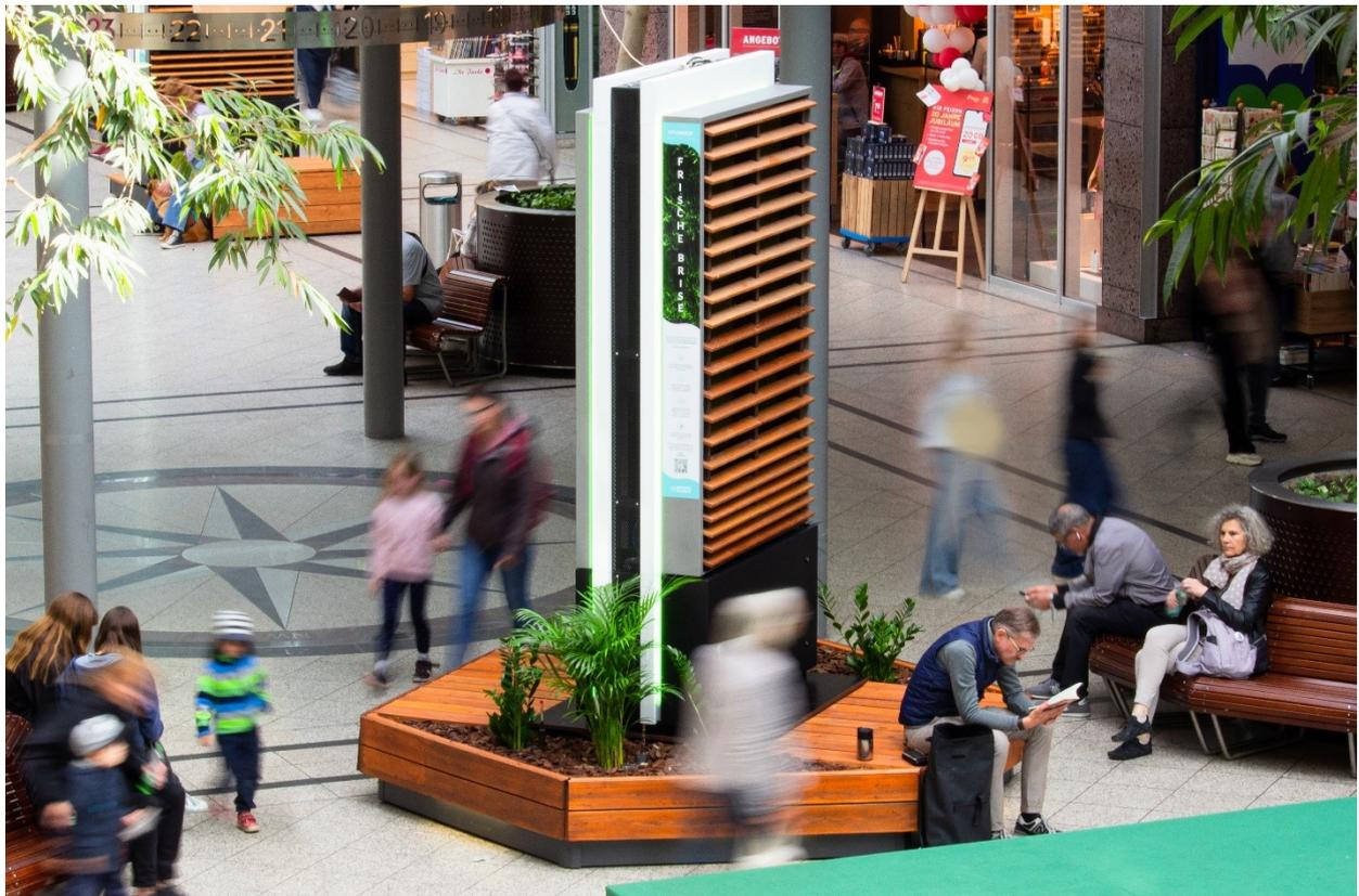
1 CityBreeze erzeugt die gleiche Kühlleistung wie 21 neu gepflanzte Bäume (bis zu 1.650 Watt) und reinigt ca. 1.400 m<sup>3</sup> Luft/Stunde – das entspricht etwa 1 Mio. m<sup>3</sup> jeden Monat
